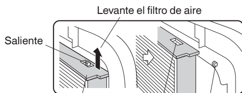
Levante el filtro de aire Saliente Filtro de aire Agujero de enganche Saliente
